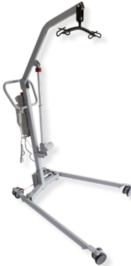
Sollevatore elettrico con struttura in acciaio, adatto anche per pazienti obesi, apertura gambe mediante attuatore elettrico. Bilanciere a quattro ganci, con possibilità di prendere il paziente da terra. Quattro ruote piroettanti di cui 2 posteriori con freno, dotate di copertura in gomma dura per facilitare gli spostamenti. Meccanismo di discesa manuale d'urgenza. Maniglioni di ampie dimensioni e buona ergonomia per garantire la massima manovrabilità. Dotato in configurazione base:
