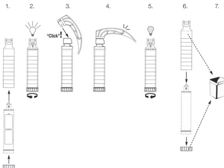
La guaina-esterna monouso HEINE XP è stata appositamente progettata per essere utilizzata con l'inserto del laringoscopio HEINE. L'inserto del laringoscopio HEINE va inserito nella guaina-esterna monouso e ruotando la base di chiusura si illumina. Dopo l'intubazione, l'utente dovrà semplicemente svitare la base di chiusura dell'impugnatura, estrarre l'inserto del laringoscopio senza rischi di contaminazione e smaltire poi la guaina con la sua base e la spatola XP.
