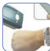
Possibilità di utilizzo dello scanner codici a barre per un rapido inserimento del codice paziente
