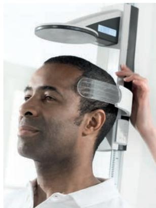
La Linea di Frankfurt permette la corretta posizione della testa, garantendo misurazioni precise.
